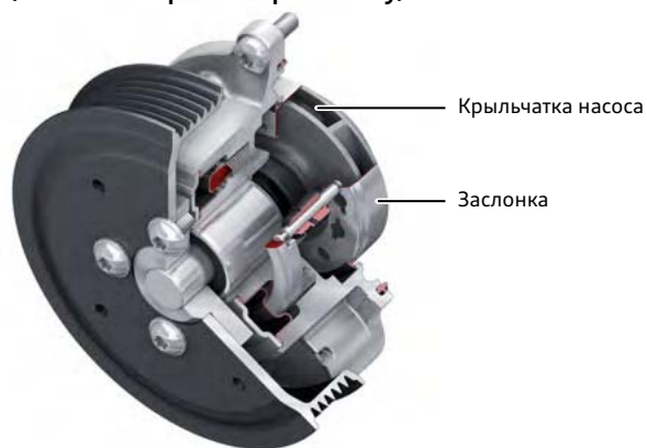
Насос охлаждающей жидкости закрыт (заслонка закрывает крыльчатку)
