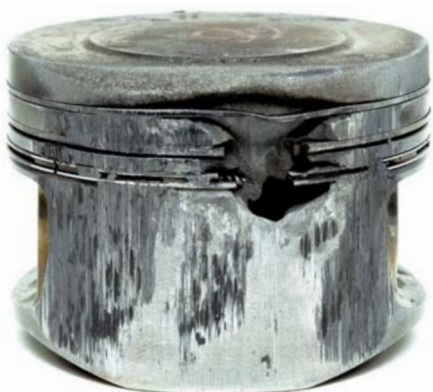
Рис. 4 Проплавленные кольцевые зоны на поршне бензинового двигателя
