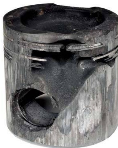
Рис. 3 Сквозной прожиг поршня дизельного двигателя
