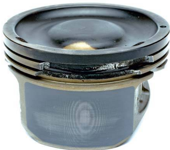
Рис. 2а Разрушенные перемычки поршневых колец
