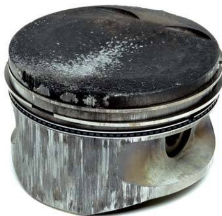
Рис. 3 Следы сильной эрозии и оплавления на головке поршня
