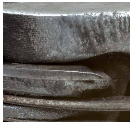
Рис. 1 Следы эрозии на поршне бензинового двигателя
