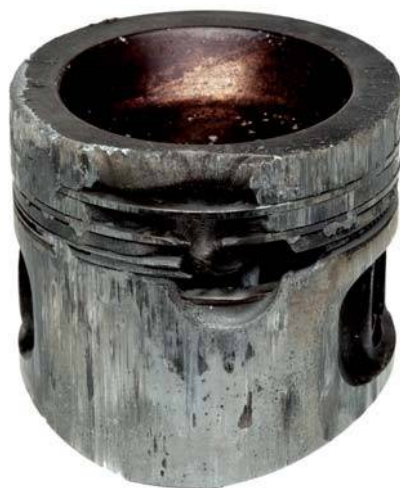
Рис. 2 Оплавленный жаровой пояс на поршне бензинового двигателя
